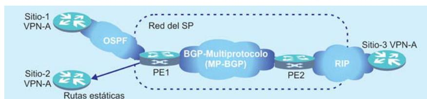
Figura 5 Protocolos de enrutamiento usados en la VPN-A
