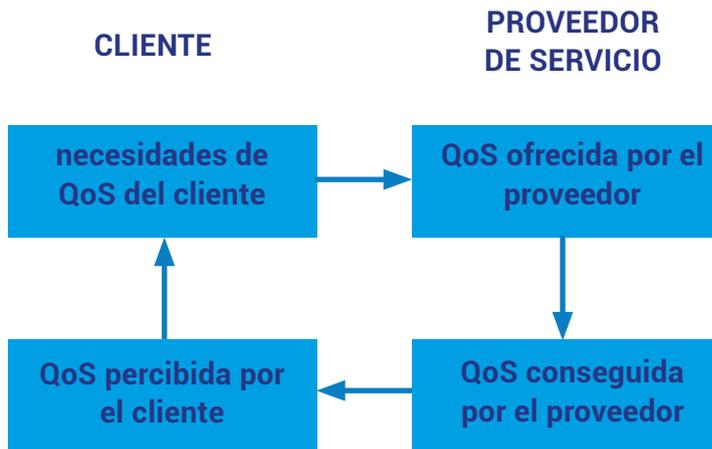
Figura 2. Modelo de referencia que propone la UIT - T - G1000 (2001) para evaluar la calidad de los servicios de telecomunicaciones
