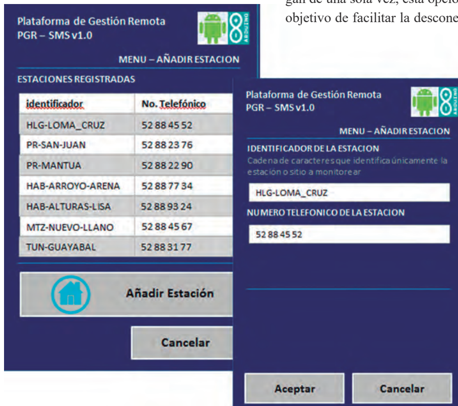
Figuras 12 y 13. Pantallas para añadir una nueva estación a la aplicación de monitoreo
