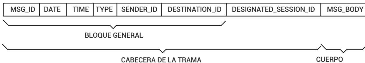
Figura 9. Estructura de trama para los mensajes que se intercambian entre el terminal de supervisión y el módulo de control de la estación
