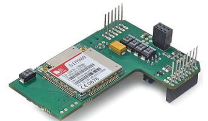
Figura 8. Módulo GPRS+GPS Quadband para Arduino y Raspberry Pi (SIM 908)
