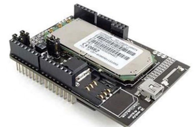
Figura 9. Módulo 3G/GPRS+GPS para Arduino/Raspberry Pi
