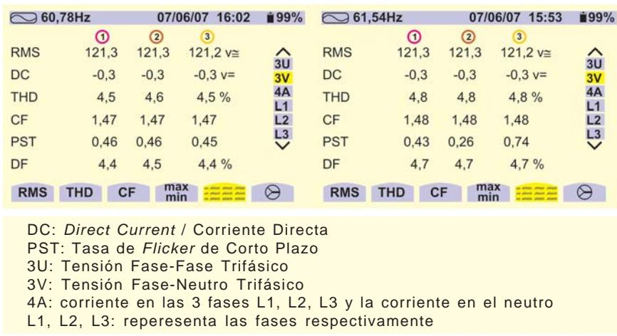
Figura 2 Imagen de los parámetros RMS, DC, THD, CF, PST y DF para los dos alternadores
