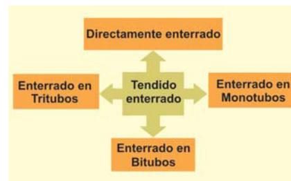
Figura 1 Formas de tendido del cable de fibra óptica
