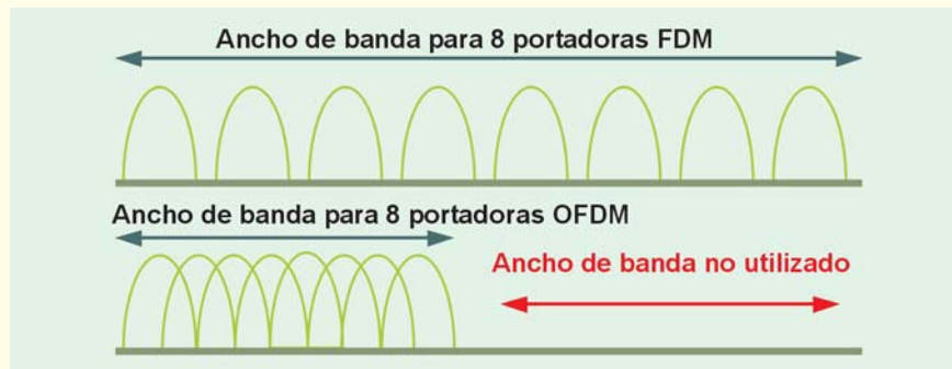
Figura 5 Diferentes técnicas de multiplexado de frecuencias
