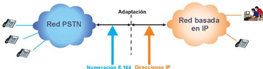
Figura 1 Interconexión entre la red PSTN y la red basada en IP
