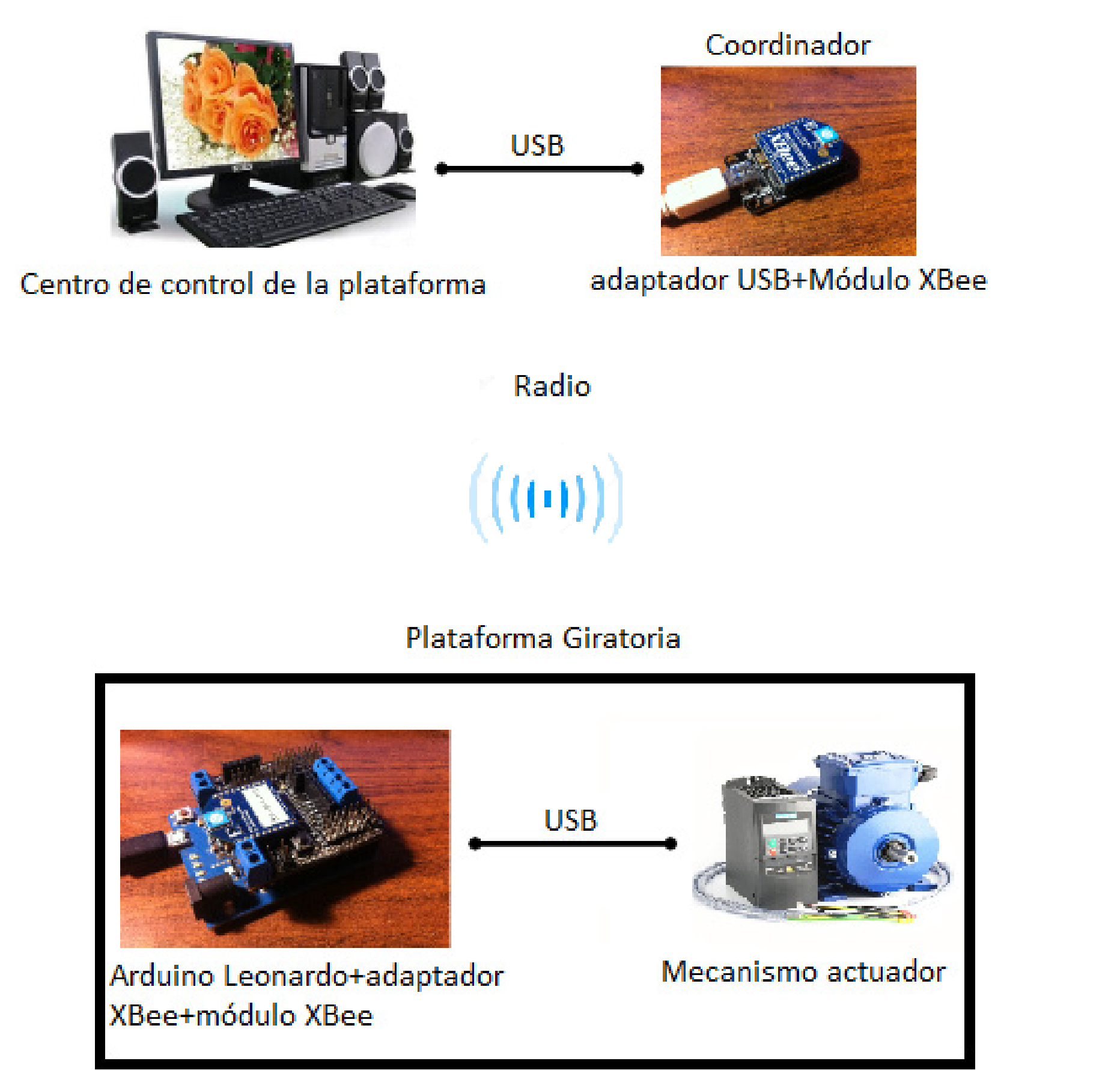
Figura 1. Diagrama en bloques del sistema de control propuesto
