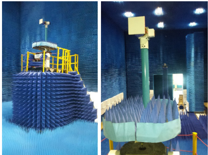
Figura. 9. Medición de los parámetros eléctricos de las antenas en la cámara anecoica
