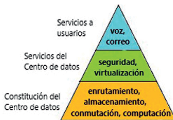
Figura 1. Arquitectura de niveles de un DC
