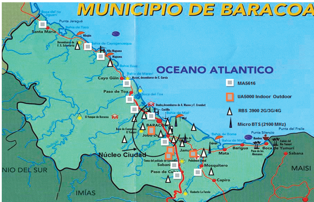
Figura 5. Red de telecomunicaciones CTLC Baracoa
