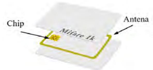
Figura 4. Estructura de una tarjeta MIFARE® 1K
