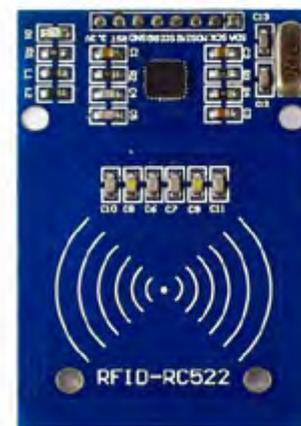
Figura 3. Módulo lector RFID con el circuito integrado RC522
