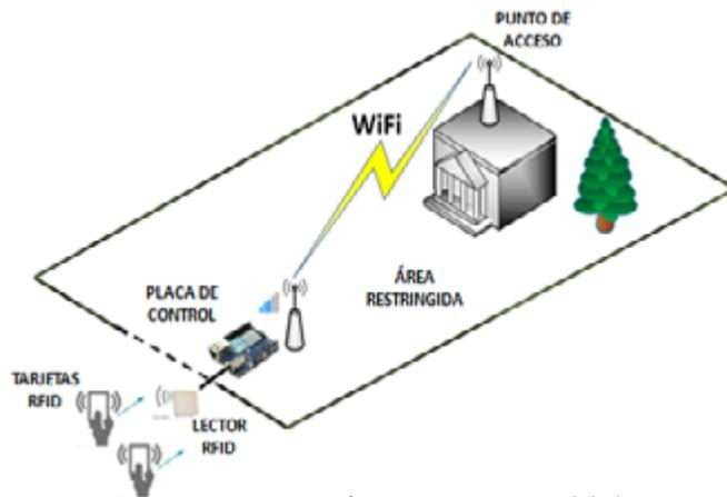
Figura 2. Estructura del sistema propuesto
