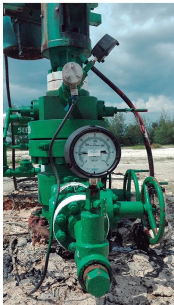
Figura 6. Sensores de presión (superficie del pozo)
