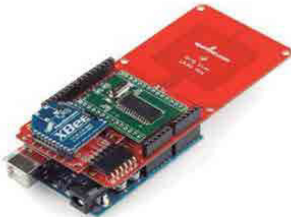
Figura 2. Chip SM130 sobre una placa de evaluación como lector RFID.
