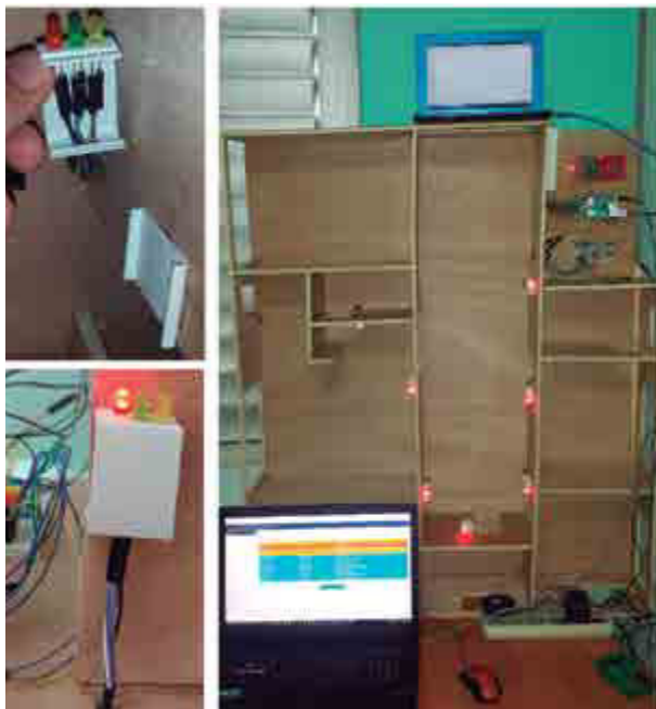
Figura 1. Leds indicadores de estado (izquierda), maqueta funcional con todo conectado (derecha), plataforma de control (abajo derecha).
