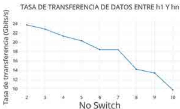
Figura 14. Impacto de la aplicación de seguridad en modo proactivo en el ancho de banda entre dos nodos de la red
