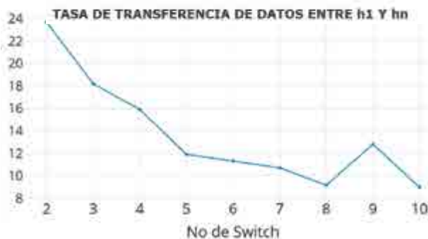
Figura 12. Impacto de la aplicación de seguridad en modo reactivo en el ancho de banda entre dos nodos de la red.
