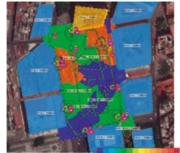
Figura 10. Células de cobertura en 2,4Ghz. Fuente: Elaboración propia.
