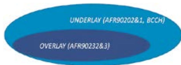
Figura 4. Celdas concéntricas AFR9023. Fuente: Elaboración propia.
