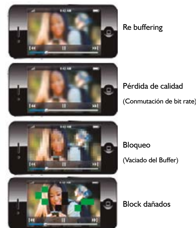
Figura 12. Efecto visual de los principales factores que degradan la QoE en el streaming de video de los OTT. Fuente: [9].
