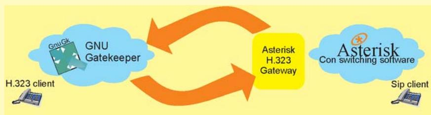
Figura 6 Interconexión de las plataformas H.323 y SIP. (Fuente: elaboración propia)
