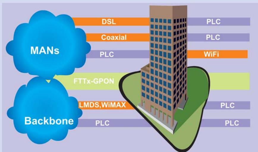
Figura 6 Combinaciones de red de acceso con solución *powerline*. (Fuente: ETECSA).
